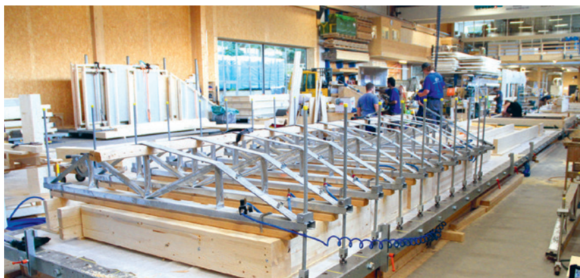
Ein einfacher Produktionsprozess garantiert die Wirtschaftlichkeit der Kasten-elemente.
